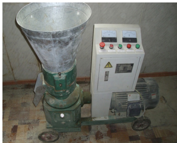
Сурет 2. Пресс гранулятор PELLET.M.LLP-200. Өндіріс қуаты - сағатына 0,200 тоннаға дейін
